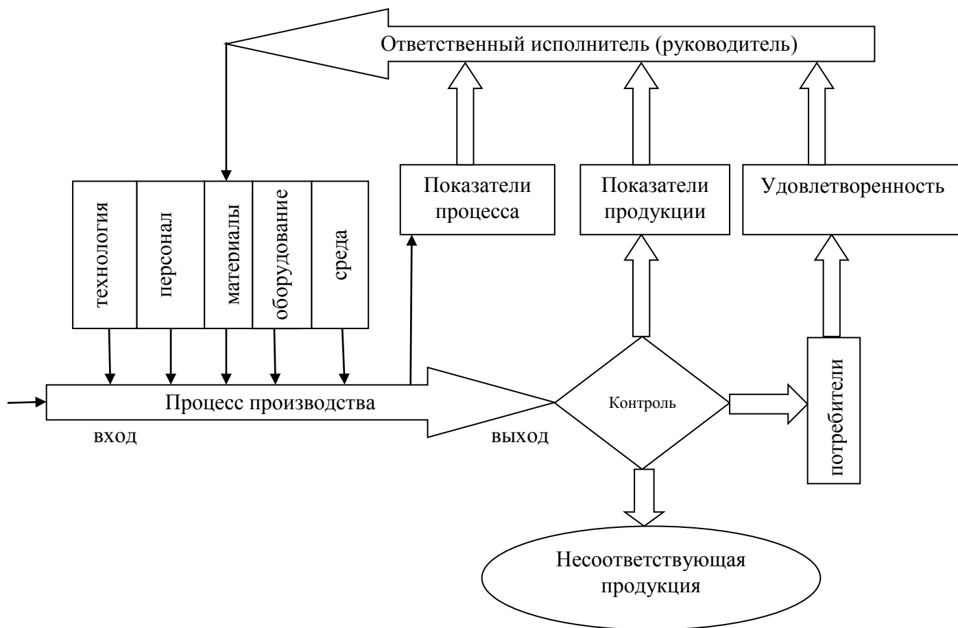
Рисунок 1 – Схема управления процессом
